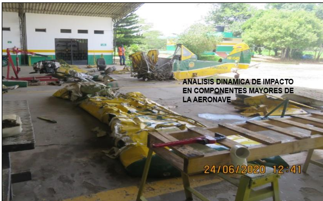
Fotografía No. 8 – Reconstrucción de la aeronave para analizar la dinámica de impacto.
