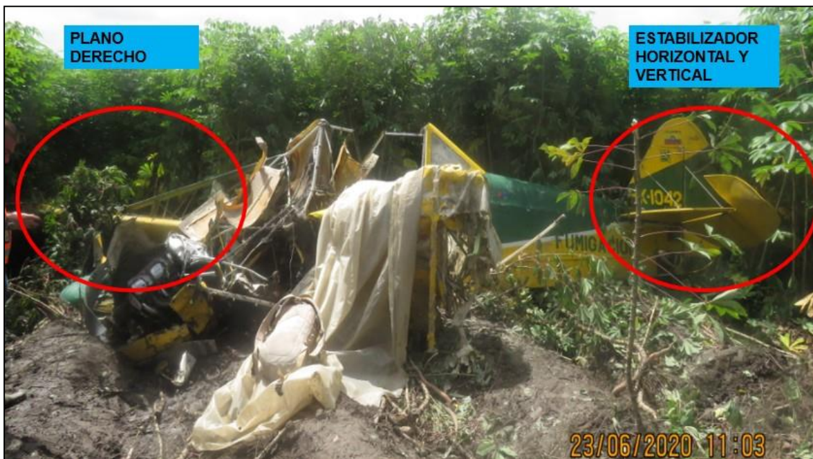
Fotografía No. 6 – Estado completo del plano derecho y del empenaje.
